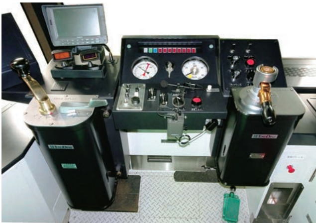
■ 図6 主幹制御器およびブレーキ制御器 Fig.6 Master controller and brake controller on the cab
