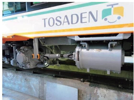
■ 図5 主電動機および駆動装置と自在軸継手を組んだ状態
