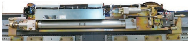
■ 電気式戸閉装置
