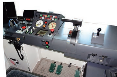
■ 図6 主幹制御器 Fig.6 Master controller on the cab
