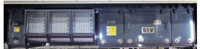
■ 2群形 編成で並列同期方式の補助電源装置
