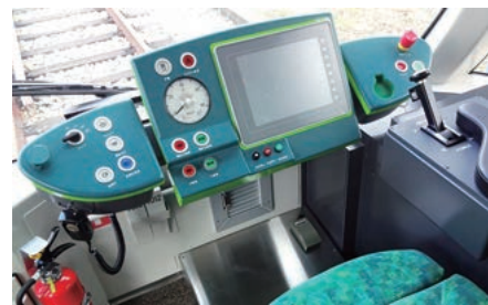
■ 列車情報システムの運転台表示器
