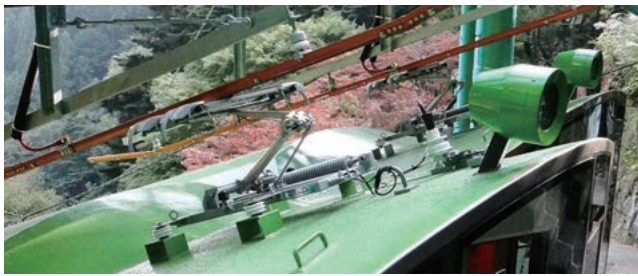
■ 図2 集電装置 Fig.2 Pantograph
