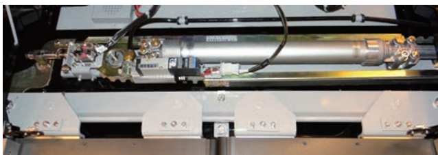
■ 図3 戸閉装置 Fig.3 Door engine
