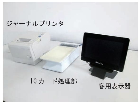
■ 図2 卓上型窓口処理機の構成機器
