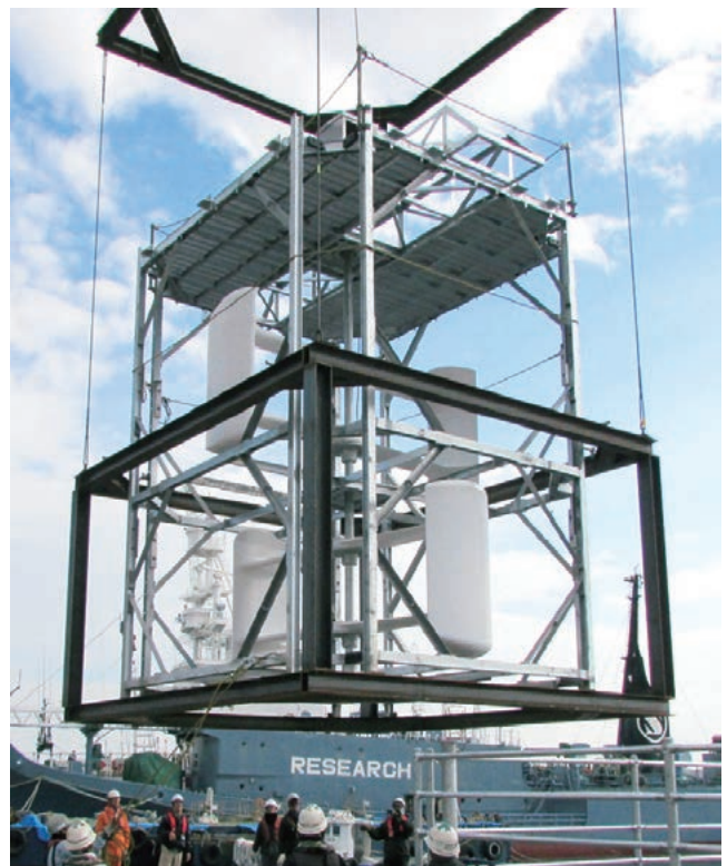
■ 図1 潮流発電装置外観
