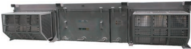
■ 図3 VVVFインバータ装置外観 Fig.3 VVVF Inverter
