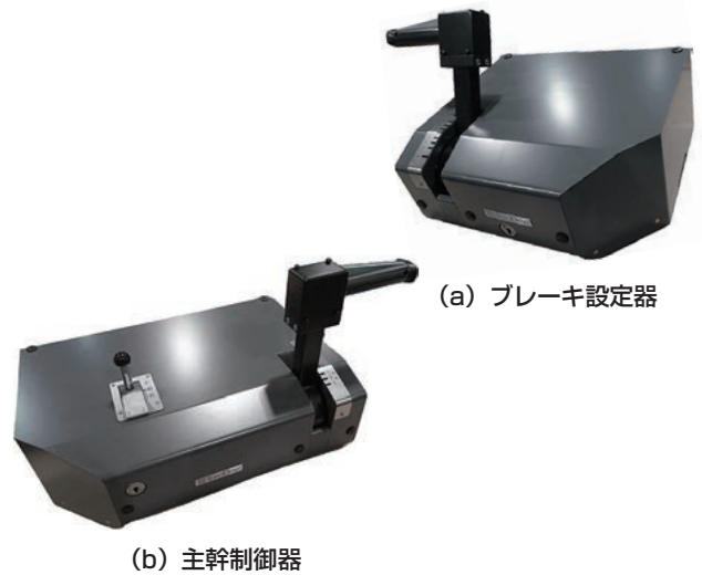
■ 図8 ブレーキ設定器・主幹制御器 Fig.8 Brake controller・Master controller
