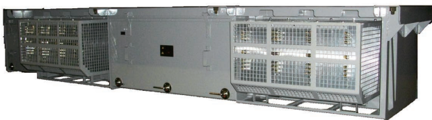
■ 図2 VVVFインバータ装置外観 Fig.2 VVVF Inverter
