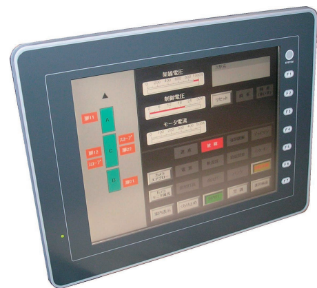
■ 列車伝送/モニタ装置画面表示の例
