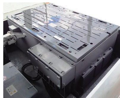
■ 屋根上搭載型補助電源装置の例
