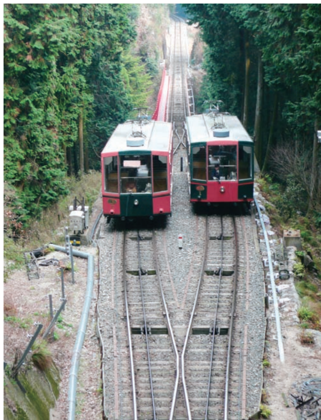
■ 図2 架線レス車両システム導入後のケーブルカー Fig.2 The cable car after removed the line
