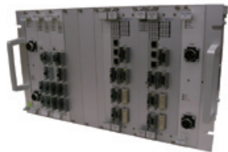
列車情報システムの CCU (Central Control Unit)
