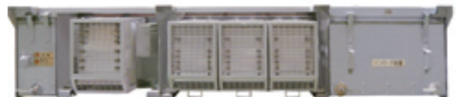
■ 図3 インバータ装置外観 Fig.3 Static inverter
