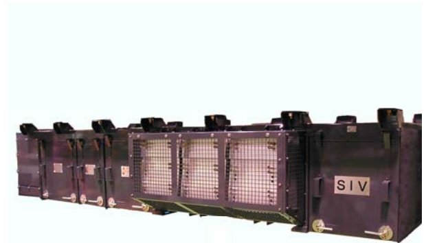
在来線用補助電源装置
