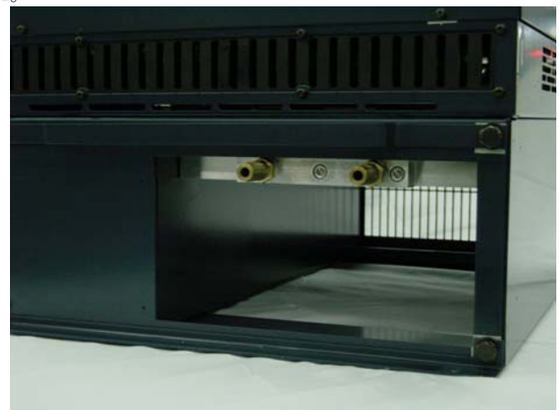
図3 ヒートシンク取付部外観
