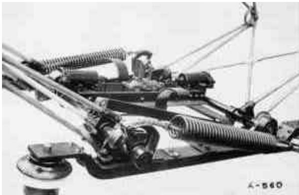
図 15 PS11 形パンタグラフの主ばね部分 Fig.15 Main springs of type PS11 pantograph
