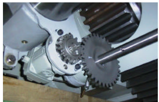
図12 ピンチローラ駆動油圧モータ Fig.12 Hydraulic motor for pinch roller
