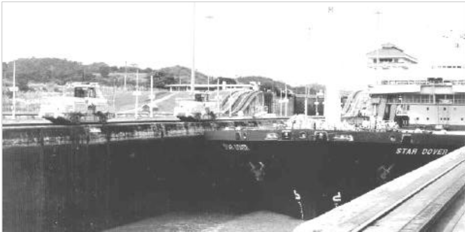
図2 パナマ運河での曳船用機関車による曳船状況
