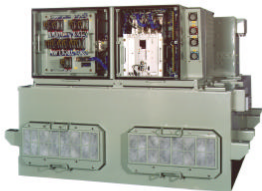
図9 コンバータ・インバータ装置 (C/I)
