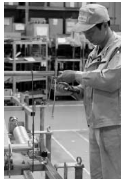
パンタグラフは少量・多品種生産のため、組み立ては人の手に頼るところが大きい。
