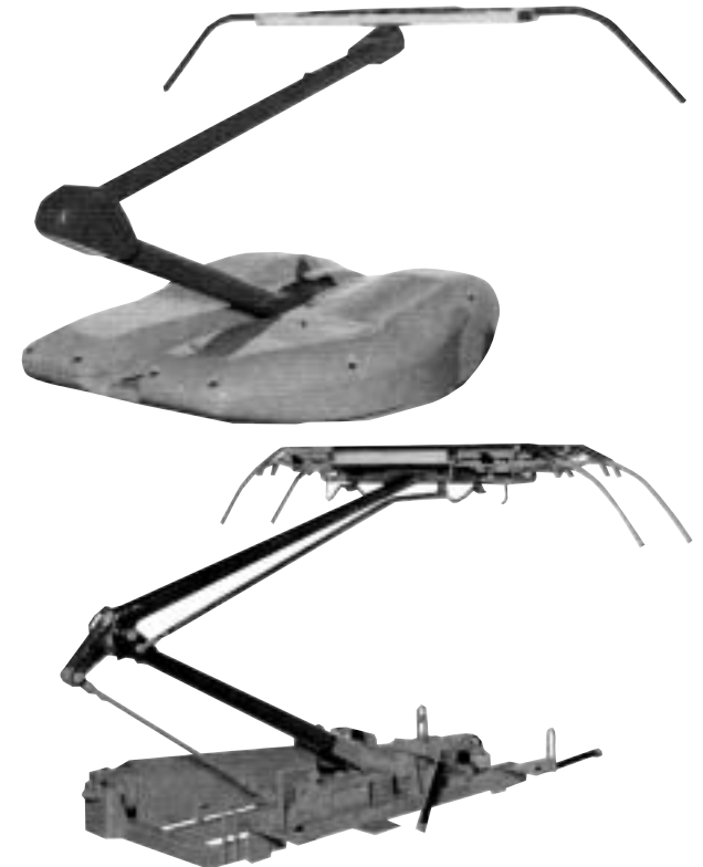
パンタグラフは少量・多品種生産のため、組み立ては人の手に頼るところが大きい。
