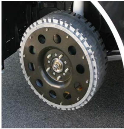
図3 インホイールモータの概観 Fig.3 Outline view of in-wheel motor
