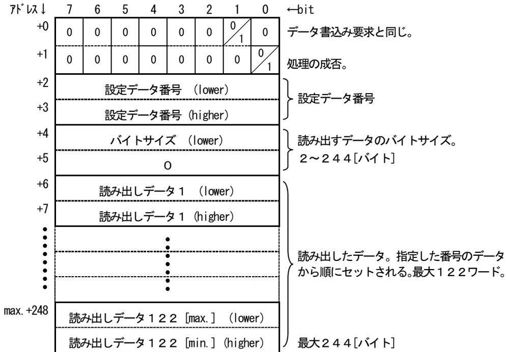
図3. 15 マスタ局データ読み出し確認SDUのdata構成（設定データ読み出し結果）
