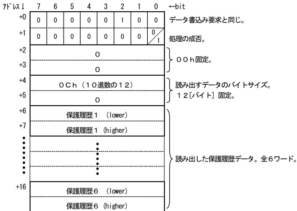
図3. 17 マスタ局データ読み出し確認SDUのdata構成（保護履歴読み出し結果）
