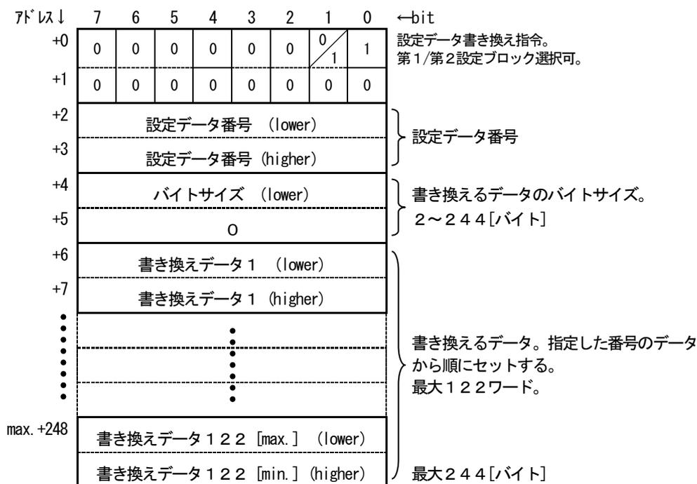
図3. 22 マスタ局データ書き込み要求SDUのdata構成（設定データ書き換え指令）
