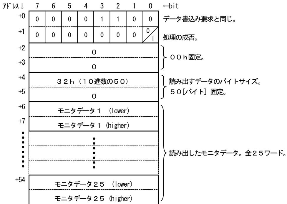
図3. 21 マスタ局データ読み出し確認SDUのdata構成 (モニタデータ読み出し結果)
