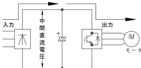
図1-1-2 力行モードのパワーフロー
