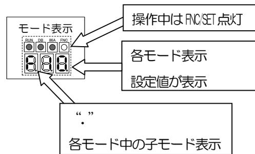
各モードの表示はLED“FNC”が点灯がしていない時は直流電圧表示です。“FNC/SET”ボタンを押すことによってLED“FNC”及び表示器に“F10”が点灯しDBユニットの各設定値を調整するモード移行します。この状態より“△”“▽”ボタンを押すことにより各設定モードのに移行し更に“FNC/SET”を押すことによって設定項目へ移行します。また、設定中にDBユニットに運転信号“52MA”を入力すると設定はキャンセルされ自動的に直流電圧表示に切り替わり設定、調整モードに切り替わりません。
