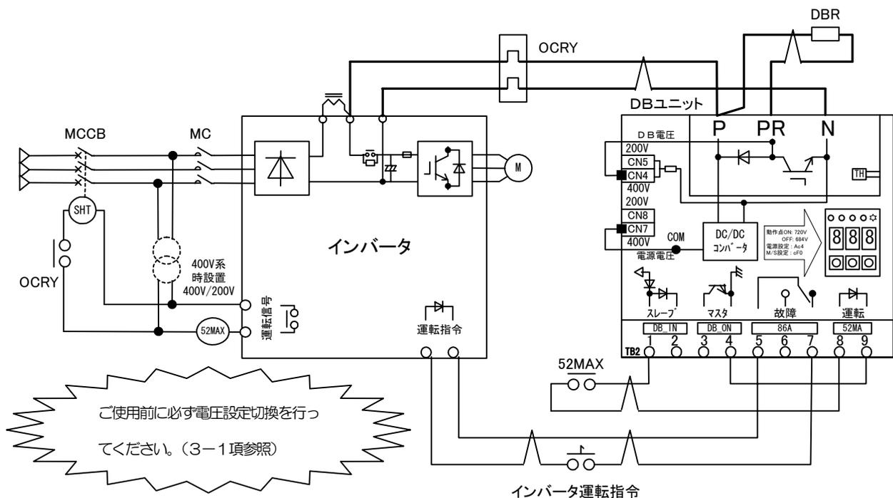
図2-2-2 50Aユニット接続図例
