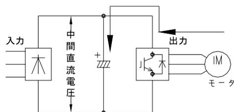
図1-1-3 回生モードのパワーフロー
