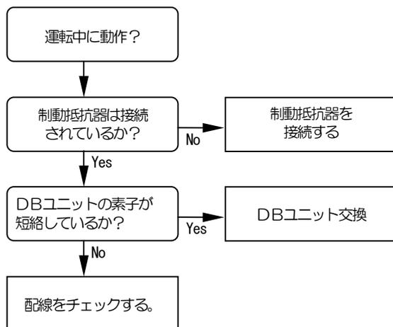
6. LED “86A “が点灯し、表示器に” FF2 “と表示（フィン過熱） ※1
