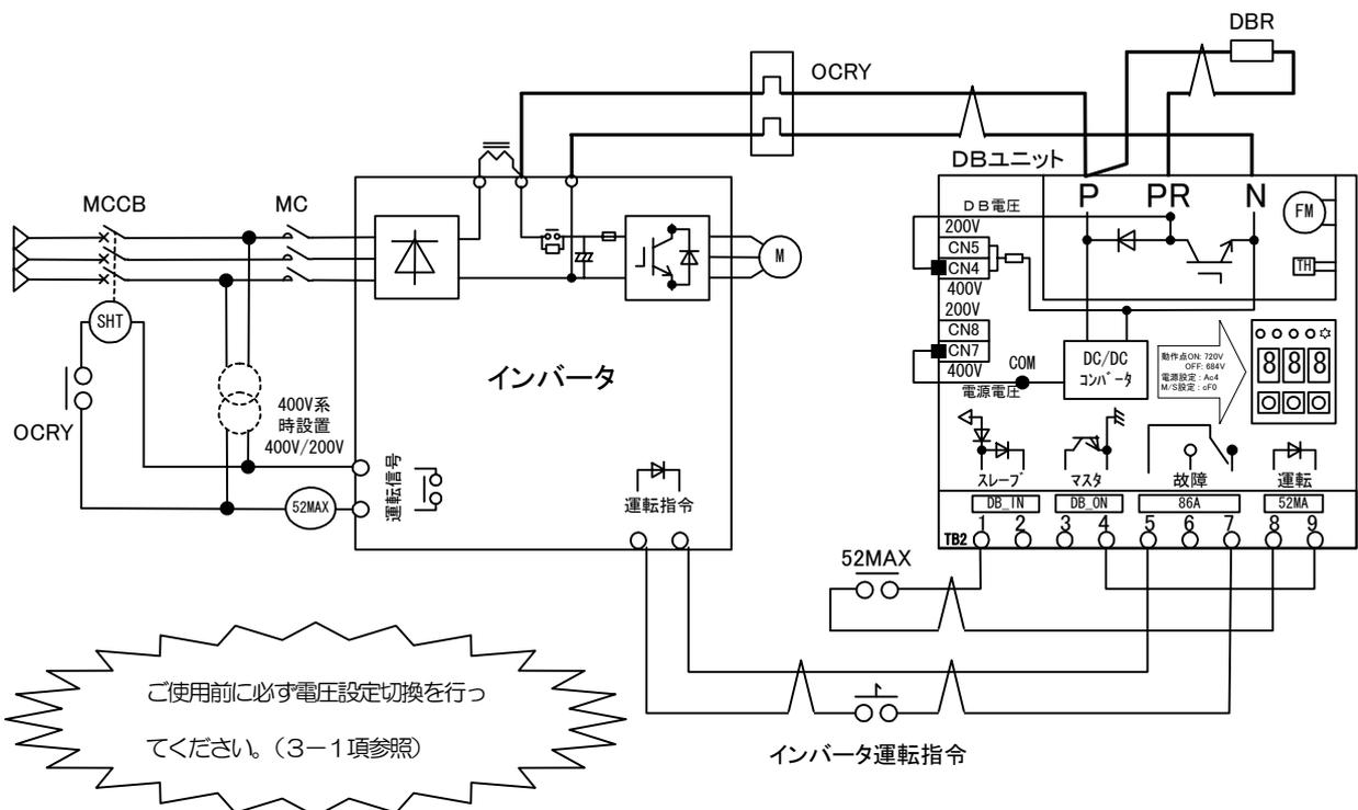
図2-3-2 200Aユニット接続図例
