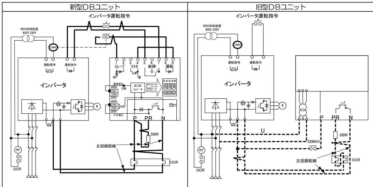
配線変更点 (旧型ユニットの波線部分を新型ユニットの太線部分に変更する必要があります。)
