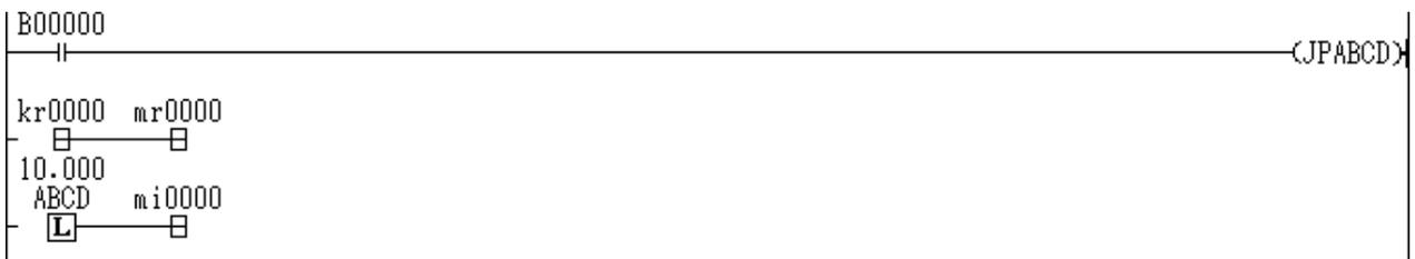
リレーB00000 が ON の時は、ラベル ABCD ラインにジャンプし、ラベル ABCD との間にあるプログラムを実行しません。
