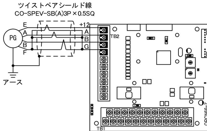
図 6. 2 誘導電動機の PG 線接続
