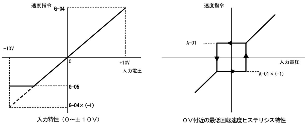
図5. 2 電圧入力0~±10Vの速度指令特性
