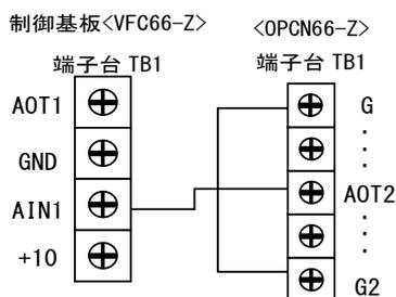
インバータの電源を切り、表面カバーを開け、<OPCN66-Z>にある端子台TB1の[AOT2]と制御基板<VFC66-Z>にある端子台TB1の[AIN1]端子間を短絡してください。
