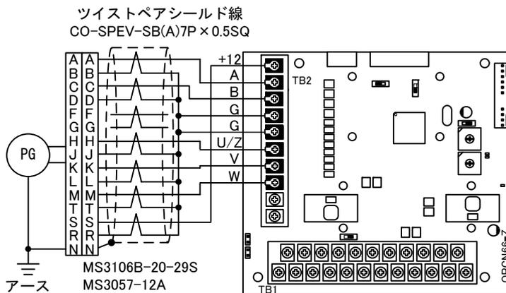
図 6. 3 EDモータの PG 線接続
