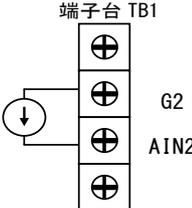
インバータの電源を切り、表面カバーを開け、<OPCN66-Z>にある端子台TB1の[AIN2]と[G2]端子間に電流電源をつないでください。
