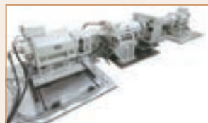
FF車用トランスミッション試験ベンチ
