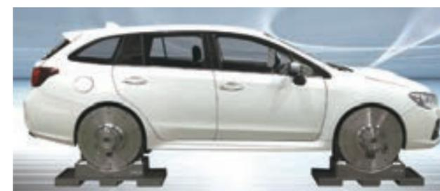
インタイヤハウスダイナモでの実車試験
