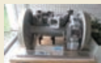
中空軸平行カルダン駆動方式の主電動機と駆動装置(小田急電鉄SE車)
