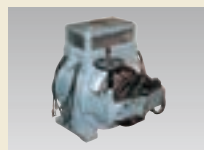
三相交流整流子電動機(シユラゲ形※のちのASモータ)
