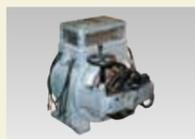
三相交流整流子電動機(シュレーゲ形※のちのASモータ)
