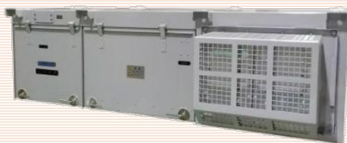
Propulsion controller (VVVF inverters)
