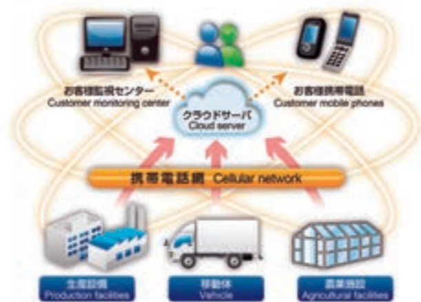
東洋M2Mソリューション システム構成例 System configuration example of Toyo M2M Solution
