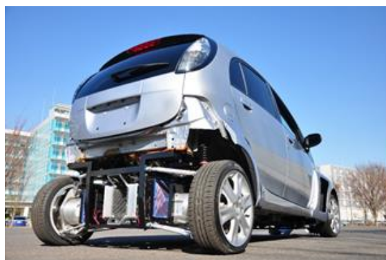
图2 装备了无线轮毂电机的试验车
