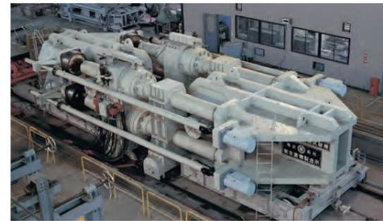
構造物引張試験機（1976年 川崎製鉄千葉製鉄所納入）
