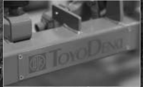
かつてはTDKの陽刻がおなじみだったが、現在、東洋電機製造製のパンタグラフにはステンレス製の銘板が取り付けられている。
