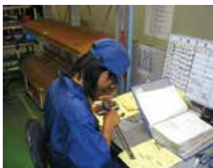
ノギスでの測定作業
