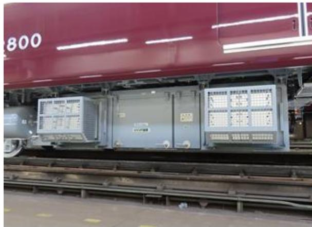
■VVVF インバータ制御装置 外観
