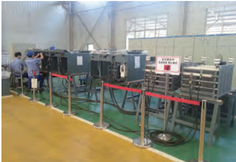
補助電源装置の試験（湖南湘電東洋電気有限公司）
