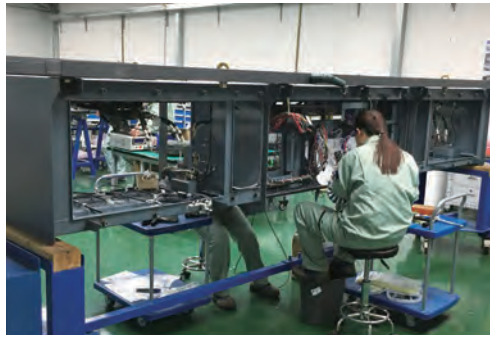
北京地下鉄向け電機品のメンテナンス (北京京車双洋軌道交通牽引設備有限公司)
