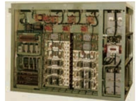
EF67形電気機関車に搭載されたCH3形チョップ装置 (1982年 国鉄納入)
