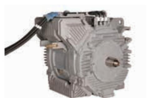
軸受オイル潤滑方式全閉内扇型主電動機 (2011年)
