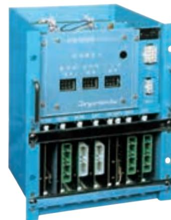
3600形車用マイクロコンピュータ仕様の制御増幅器（1982年 京成電鉄納入）
