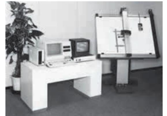
ベクタライザ ドラステム1000・図形入力装置 (1984年)
