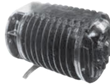
24P 6kg-m 赤熱銅塊運搬用ローラモータ
