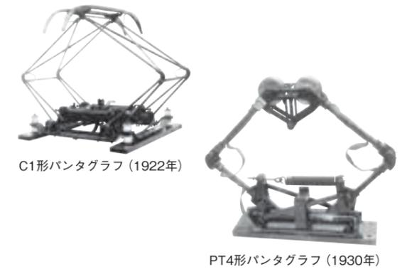
たC形は、インチ単位であったA形を国内仕様のメートル法に改め、枠組みの摩擦を減らすなど独自の改良を施した。これらの詳細はP228「パンタグラフ開発の歴史」にも記述があるので、併せて参照いただきたい。
