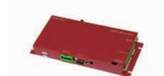
遠隔監視制御システム対応端末μTOPcm (2007年)
