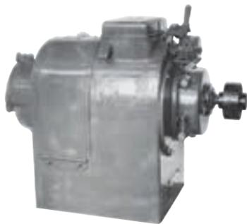
4P 5.8HP 三相分巻整流子電動機
